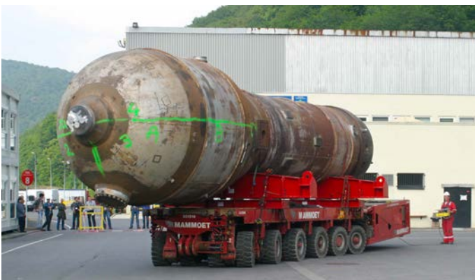
Générateur de vapeur utilisé en cours de manutention sur le site EDF de Chooz (Ardennes)
